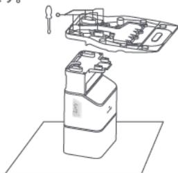
注意：ドックを逆さまにするときは、ゴミ収集ボックスカバーの落下に気を付けてください。
